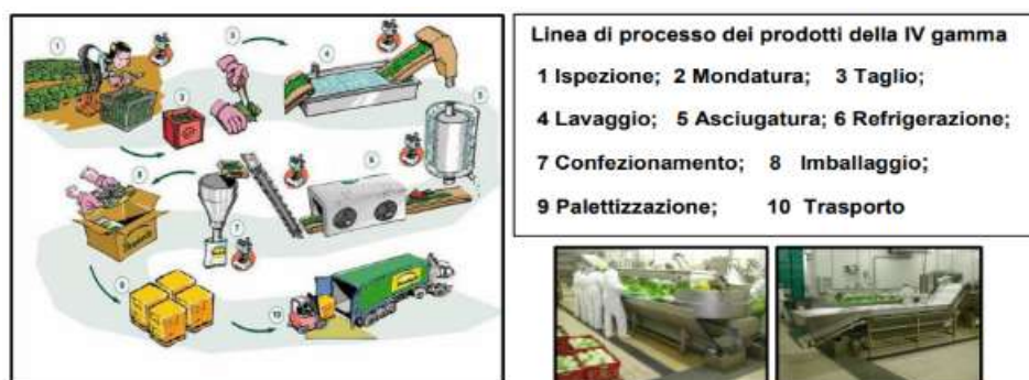
Figura 5. - Operazioni della linea di processo dei prodotti della IV gamma
