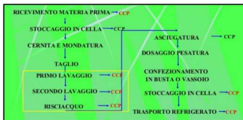
Figura 2.- Diagramma di flusso del processo di lavorazione dei prodotti della IV gamma
