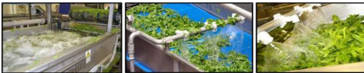
Figura 8.- Lavaggio e la sanificazione dei vegetali per la rimozione di patogeni e batteri
