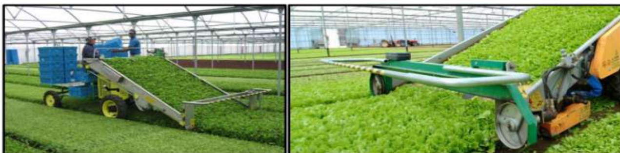
Figura 4.- Operazioni di taglio e scavo degli ortaggi
