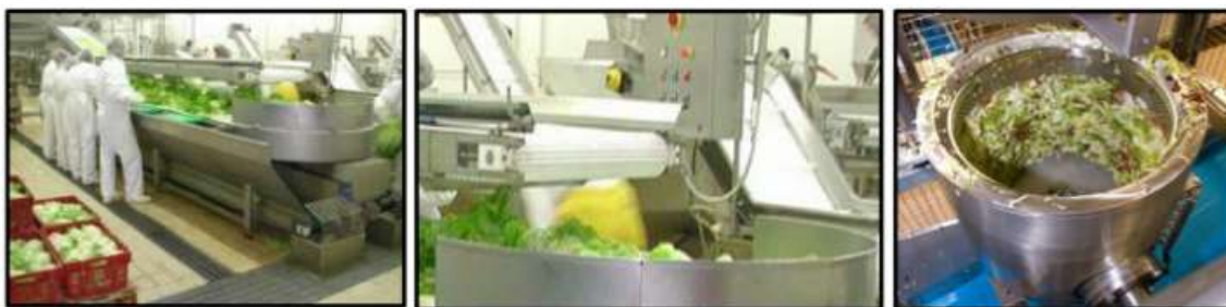
Figura 9. Centrifugazione degli ortaggi per eliminare residui di acqua sulle foglie
