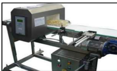
Figura 11.- Immagine di metal detector per linea di confezionamento degli ortaggi
